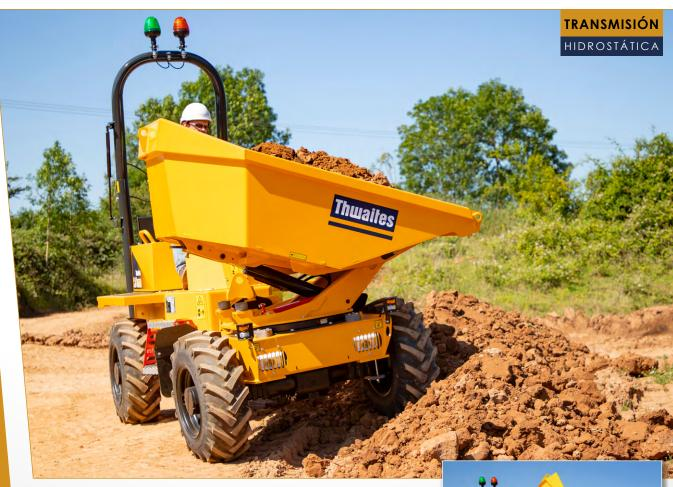
El dumper de fase V con tolva giratoria de 2,3 toneladas de Thwaites se ha fabricado pensando en los contratistas y arrendatarios, para garantizar la seguridad del operario, reducir el riesgo en la zona de trabajo y mejorar el rendimiento. Con un motor Yanmar de 18,4 kW y 3 cilindros, que proporciona 107 Nm de par máximo para desarrollar una tracción y un control óptimos, esta máquina cuenta con una transmisión hidrostática que ofrece un manejo sencillo y directo.
